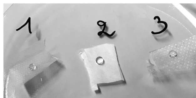
Les 3 différents tissus composant un masque chirurgical, de l'intérieur (1) vers l'extérieur du masque (3). Le tissu central hydrophobe (2) transperce dès la première projection.
