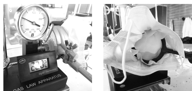
Figure 7: Photos du dispositif expérimental utilisé pour le test de résistance à la diffusion d'une solution aqueuse.
